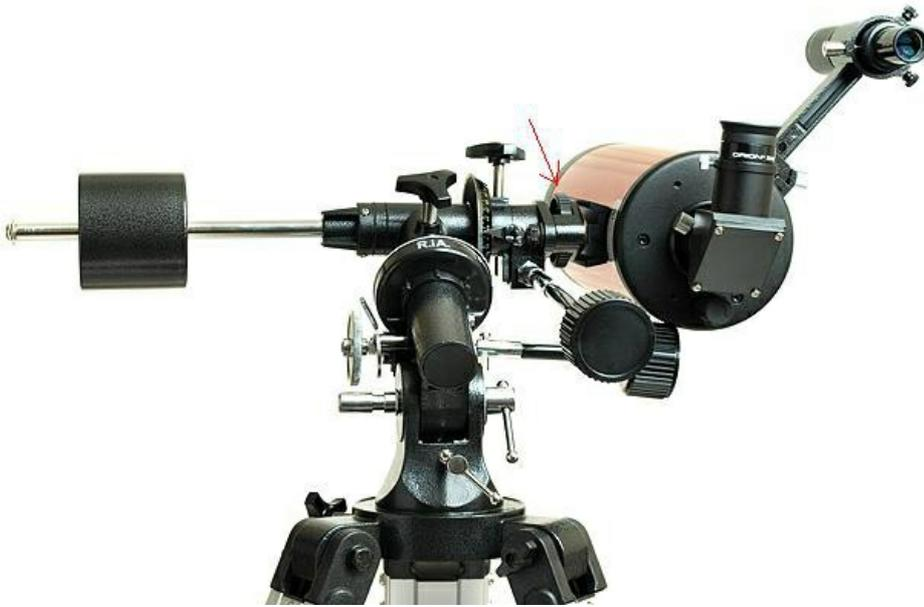
Монтировка EQ-2 хорошо подходит для данной трубы. Из-за того, что труба телескопа короткая и легкая, её вес и габариты практически не влияют на устойчивость и не вызывают тряски во время наблюдений. Ручки механизмов тонких движений имеют гибкие короткие тросики и широкие рукоятки, поэтому держать в руке и крутить их весьма удобно. Полочка для аксессуаров крепится к треноге тремя винтами-"барашками" и придает ей дополнительную устойчивость.
