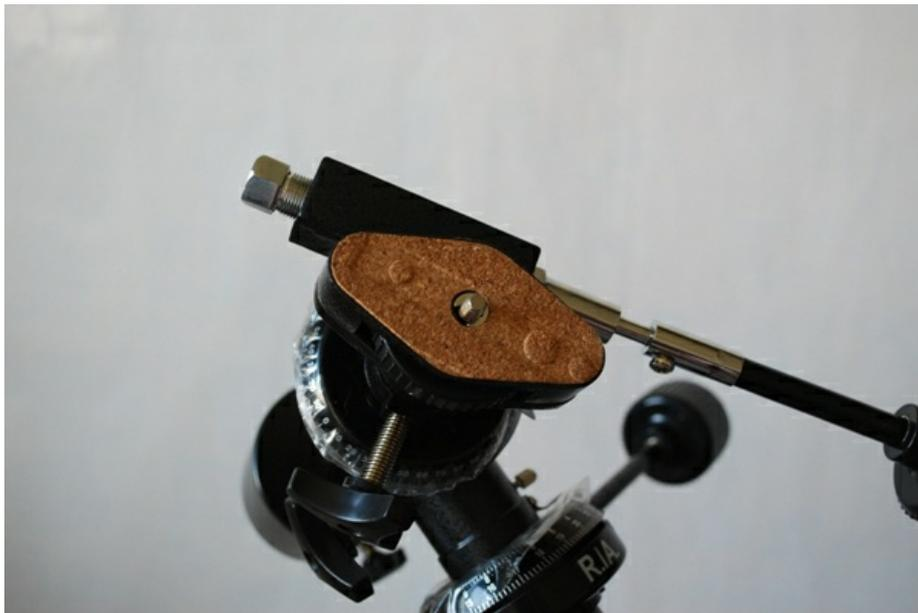
Закрепление трубы на монтировке осуществляется путем вертикального вкручивания всего лишь одного болта в крепление на телескопе.
