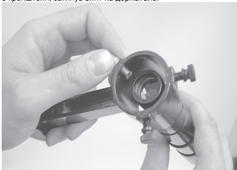
Рисунок 3. Оттяните подпружиненный натяжитель и вставьте искатель в кронштейн.
