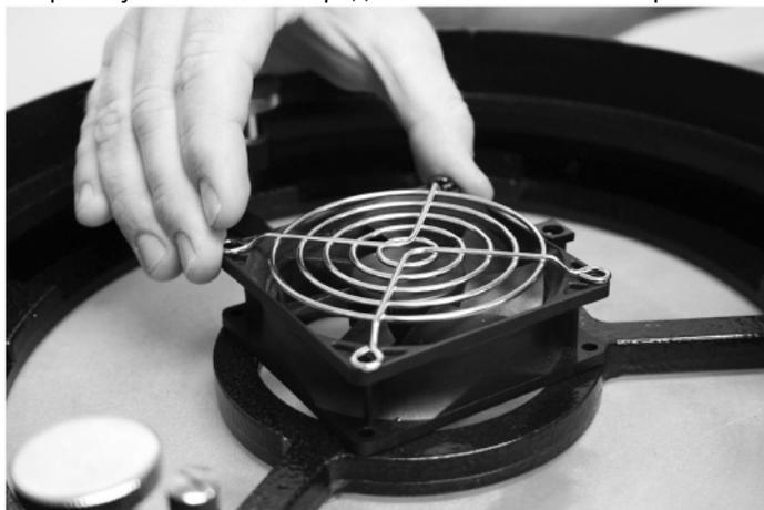
**Рисунок1.** Выровняйте отверстия в вентиляторе и крышке вентилятора с отверстиями с задней стороны корпуса зеркала.
