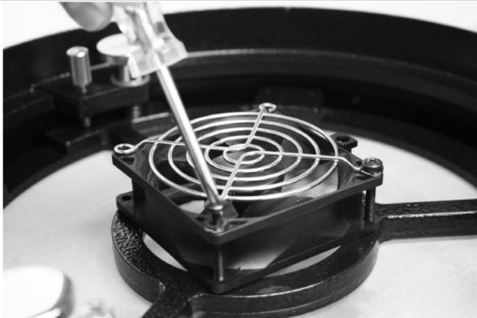
**Рисунок 2.** Присоединение вентилятора к корпусу зеркала.
