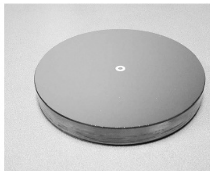
Рисунок 6. Центр первичного зеркала теперь отмечен, и зеркало можно установить обратно.
