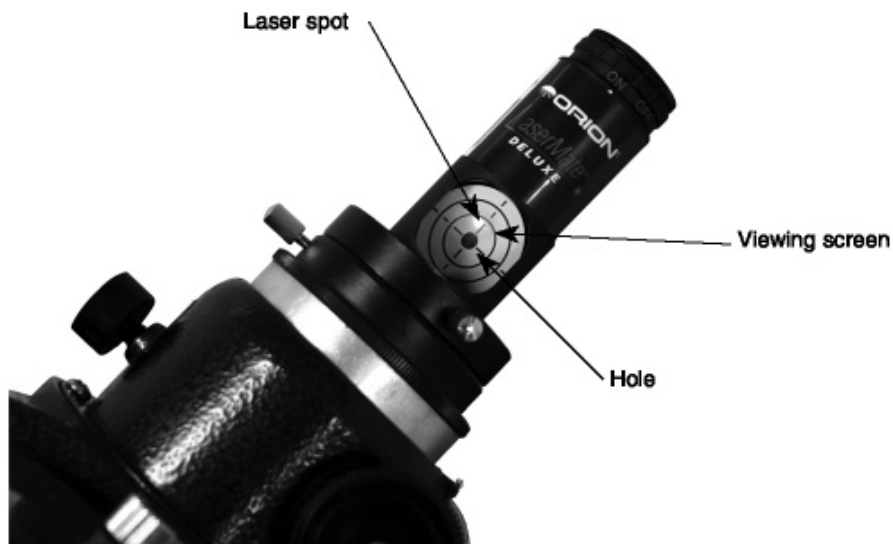
Рисунок 10. Лазерная точка отражается от экрана LaserMate Deluxe. Теперь надо отрегулировать наклон зеркала, чтобы лазерная точка ушла в отверстие.
