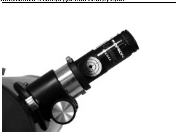
Рисунок 7а, 7б. LaserMate Deluxe вставляется непосредственно в выдвижную часть фокусировщиков 1.25" (слева). Если у Вас фокусировщик 2", Вам следует использовать дополнительный переходник 2"-1.25" (справа).
