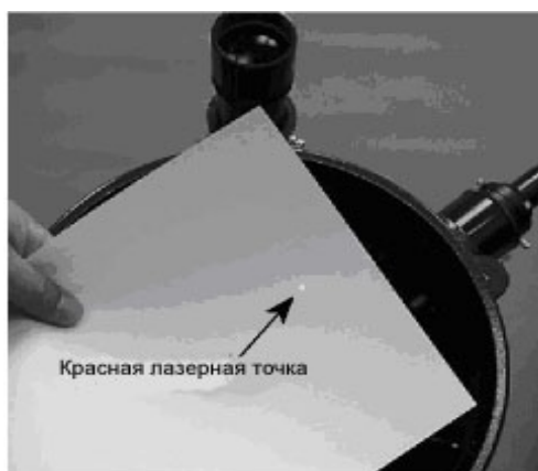
Рисунок 8. Поместите лист белой бумаги на переднюю сторону оптической трубы. Избегайте попадания лазерного луча в глаза.
