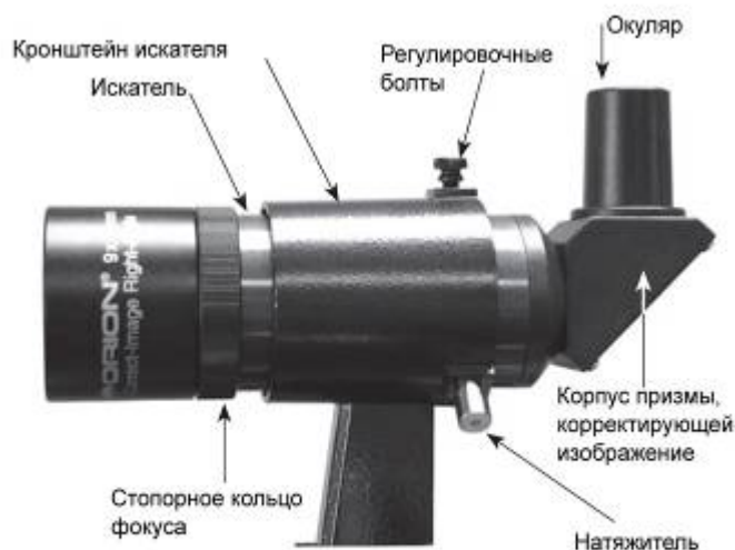
Рисунок 12а. 9х50 прямоугольный, корректирующий изображение искатель и кронштейн (6х30 в модели ХТ6)
