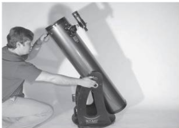
Рисунок 15. Вращайте ручку натяжения до тех пор, пока телескоп не будет сбалансирован по высоте. Телескоп при этом должен легко двигаться, не смещаясь в сторону, когда Вы его отпускаете.
