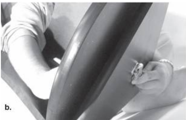
Рисунок 4. Для соединения оснований, слегка наклоните их, как показано. Не кладите их полностью (а). Удерживайте шестигранный болт ключом с одной стороны (b), одновременно поворачивая другой конец винта азимутальной оси.
