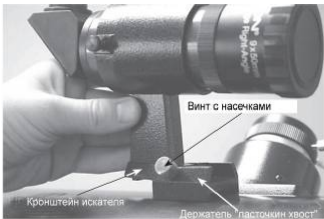
Рисунок 12b. Установка искателя.
