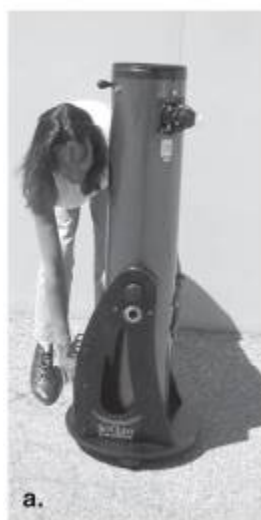
Рисунок 17. При переноске телескопа SkyQuest IntelliScope в собранном виде следует соблюдать осторожность. (а) Установите телескоп вертикально. Возьмитесь за ручку на основании, придерживая другой рукой трубу, чтобы она не поехала вниз и не ударилась о землю. (б) Аккуратно поднимайте основание, придерживая трубу. (с) Придерживая трубу одной рукой, несите ее параллельно земле. Перед переноской сначала убедитесь, что Вы сможете поднять и нести телескоп в сборе.
