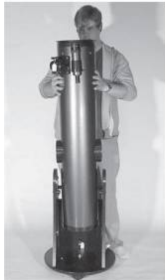
Рисунок 9. Поднимите оптическую трубу и установите ее на монтировку Добсона, так чтобы высотные подшипники встали на опорные цилиндры. Установите оптическую трубу, как показано. Не ударьте плату коннектора энкодеров или вертикальный стопор
