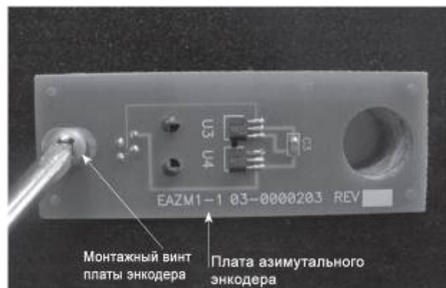
Рисунок 3. Установка платы азимутального энкодера. Выставьте на одной оси большое отверстие в плате энкодера и центральное отверстие верхнего основания
