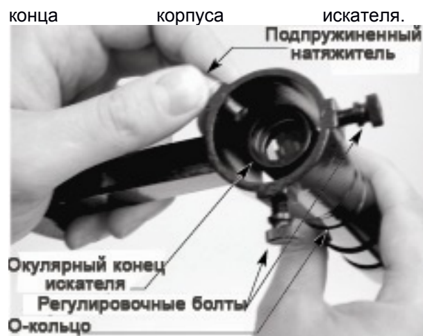
Рисунок 3. Чтобы установить искатель в крепление оттяните подпружиненный натяжитель, когда вставляете окулярный конец искателя в крепление.
